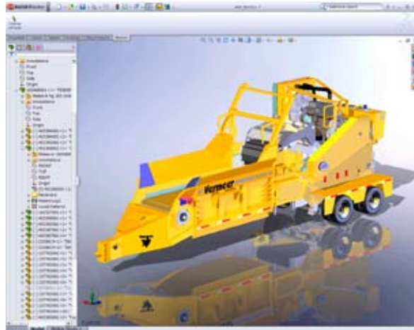
3D-CAD-MODELL EINER HORIZONTALEN SCHLEIFMASCHINE (BILD MIT FREUNDLICHER GENEHMIGUNG VON VERMEER ENVIRONMENTAL EQUIPMENT, PELLA, IOWA, USA)
